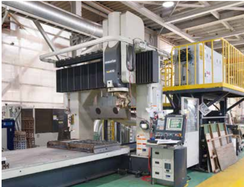
Komatsu NTC TLM-610 三次元5軸制御レーザ加工機
