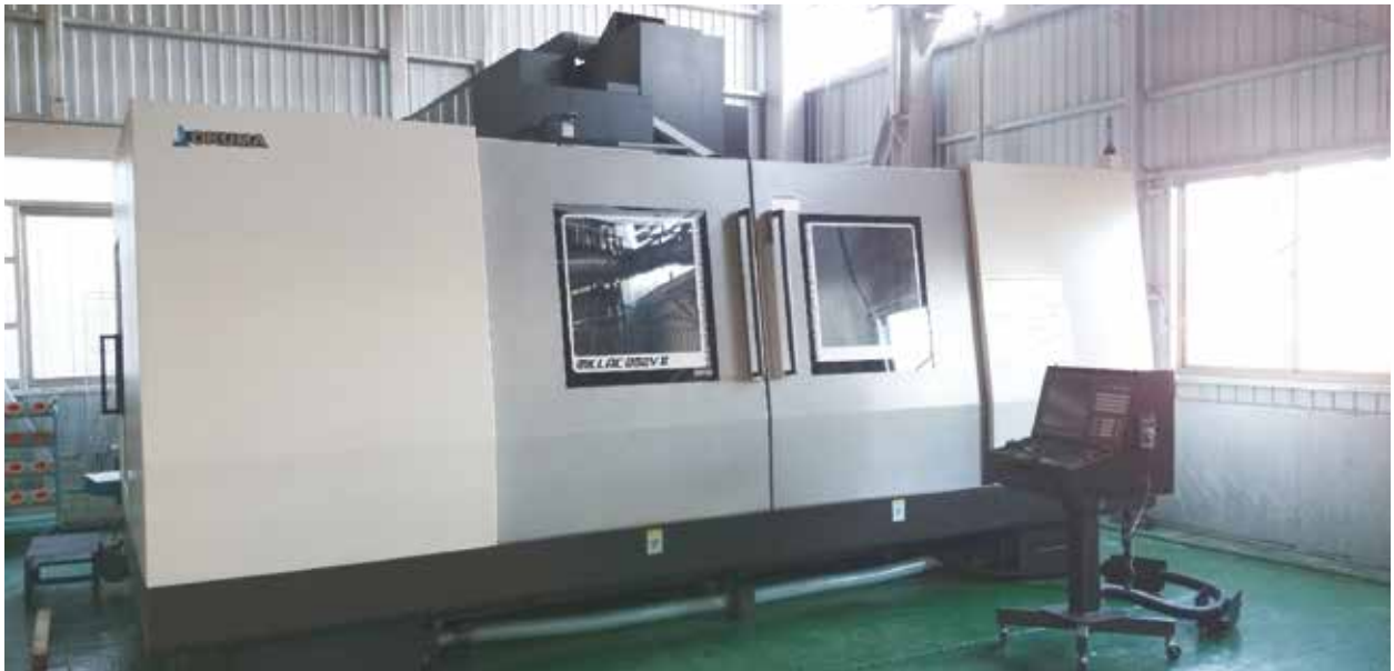
移動量 2050(X)×850(Y)×750(Z) 主軸最高回転数 6000回転
