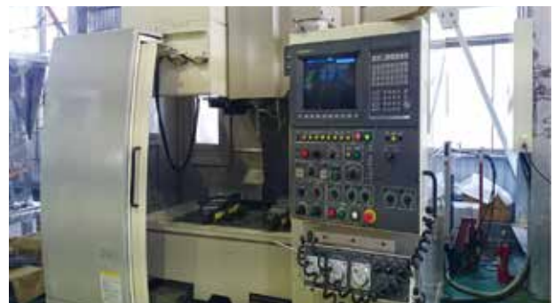
移動量 2050(X)×850(Y)×750(Z) 主軸最高回転数 6000回転
