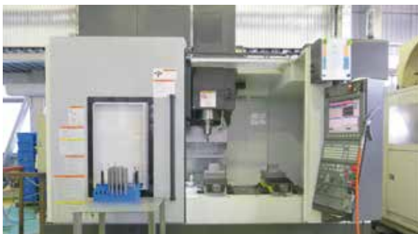
移動量 1000(X)×510(Y)×520(Z) 主軸最高回転数 10000回転
